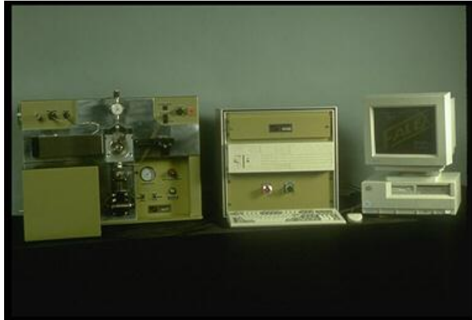
Figura 28. Máquina de desgaste diseñada por Falex [24].
