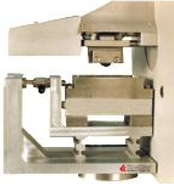
Figura 27. Máquina de desgaste recíproca diseñada por Koheler [23].
