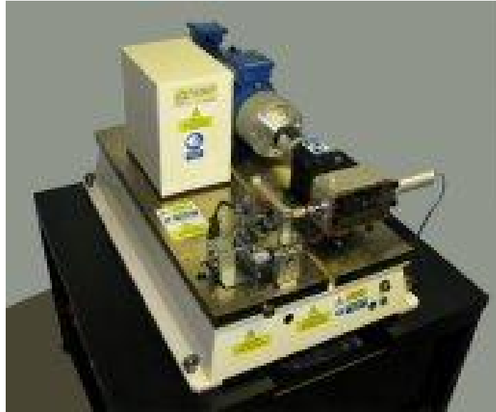
Figura 25. Máquina tribológica Plint TE77 [22].
