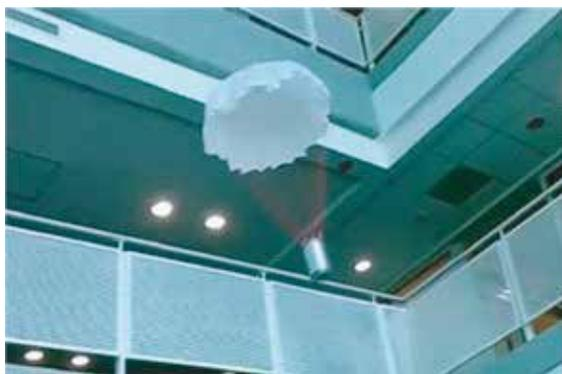
Figura 5. Prueba de despliegue del paracaídas.
