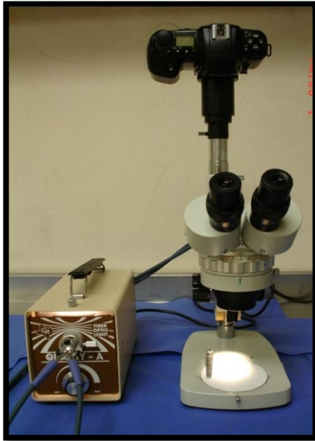
Fig.9- Microscopio Estereoscópico y Fibra óptica. (Fotos foramen)
