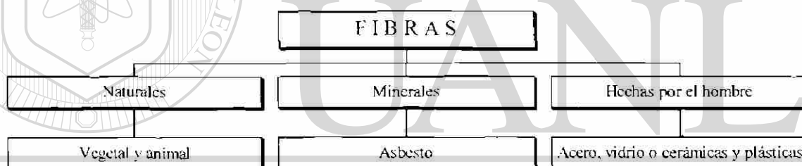
Fig. 1 Clasificación de las fibras según su origen.- Las fibras minerales y las hechas por el hombre señaladas en esta figura son las que tienen mayor aplicación como refuerzo en el concreto [2].
