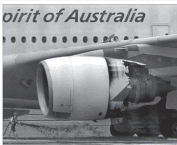
Los bomberos se acercan a la turbina dañada del Airbus 380 de Qantas en el aeropuerto de Singapur. / 10
