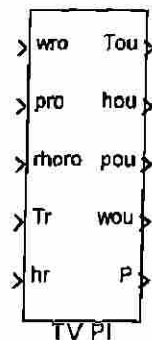
Fig. 3.36 Subsistema de la sección de presión intermedia de la turbina de vapor.
