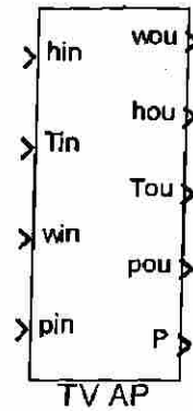
Fig. 3.35 Subsistema de la sección de alta presión de la turbina de vapor.
