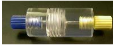
Figura 6. Preconcentrador en flujo que consta de dos cilindros de polimetilmetacrilato (PMMA).
