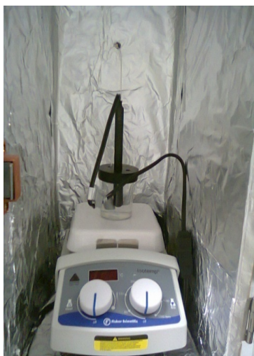
Figura 8. Reactor fotocatalítico utilizado en la degradación de ISO y PIRA.
