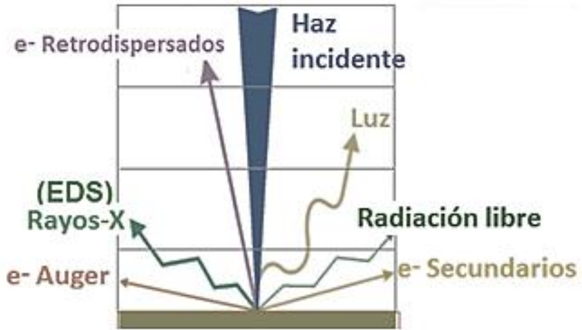
Figura 7. Posibles señales producidas por la interacción del haz de electrones de alta energía con la muestra en el microscopio electrónico de barrido.
