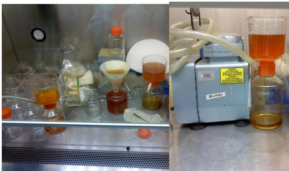
**Fig. 8.** Proceso de filtración llevado a cabo en cada uno de los tratamientos después de finalizado el tiempo de fermentación.
