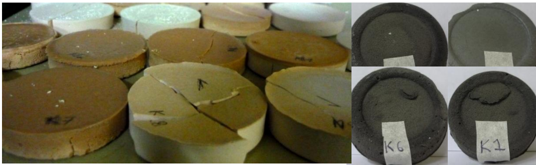
Figura 40. Muestras curadas durante 24 horas a alta temperatura de 85°C.
