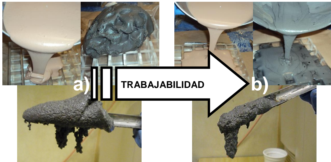
Figura 43. Incremento en la trabajabilidad de pastas y morteros al utilizar una mezcla de activadores a) NaOH+SS y b) KOH+SS.
