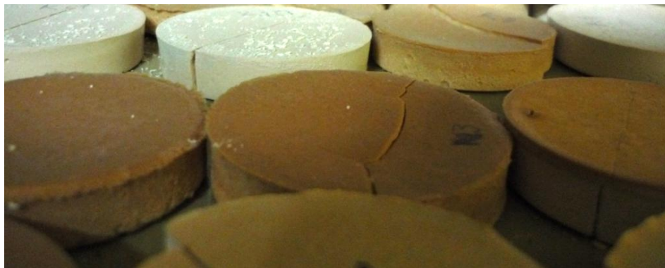
Figura 19. Muestras curadas durante 24 h a 85°C.
