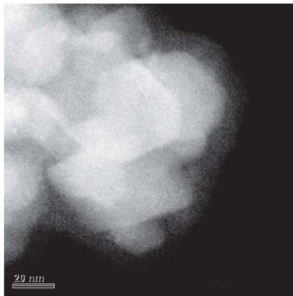
Fig. 5. Micrografía del análisis por MET correspondientes a la muestra de \text{NaTaO}_3:\text{La} preparada por sol-gel, y calcinada a 600^\circ\text{C} .
