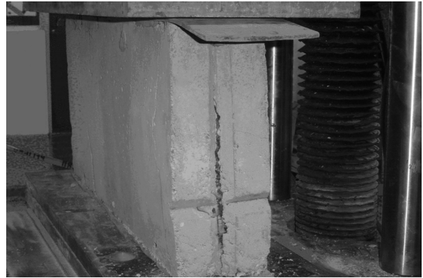
Fig. 3. (a) Agrietamiento vertical en el plano de los envases de PET.
