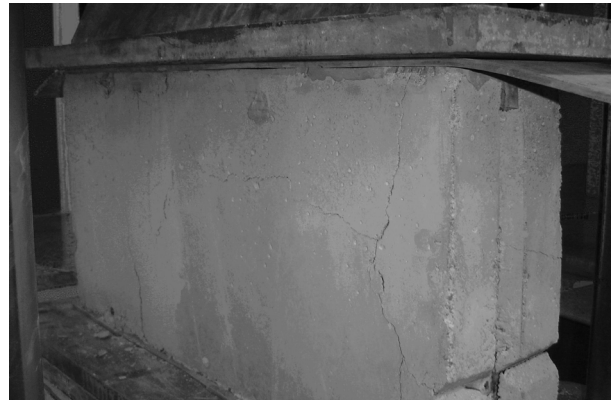
Fig. 3. (b) Patrón de agrietamiento de los bloques de concreto aligerado con envases de PET sujetos a compresión.
