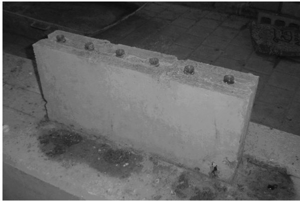
Fig. 2. Bloque de concreto aligerado con envases de PET.
