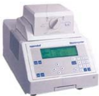
Fig. 2. Termociclador (Mastercycler® gradient thermal cycler). 9 A estos aparatos se les atribuye junto con las ADN polimerasas termoestables el permitir automatizar por completo la PCR.
