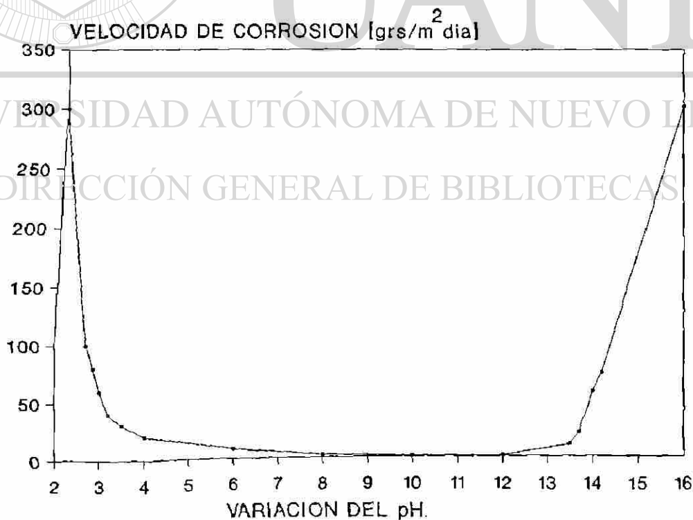
Figura 2. Efecto del pH sobre la corrosión [Ref 2].
