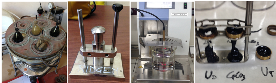
Figure 5.5 – Fillers Ut and Ud characterization devices. a)volumetric mass (EN 1097-7); b)Rigden voids (EN 1097-4); c) d) Delta Ring & Ball (EN 13179-1).
