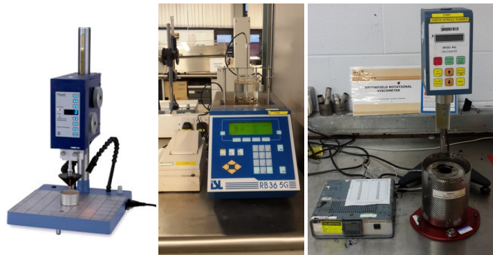
Figure 6.1 Setematic penetrometer – figure 1 (EN1426); RB365G Ring and Ball (EN1427); Brookfield Rotational Viscosimeter (EN 12596).
