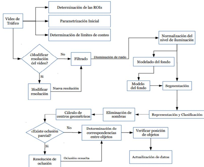
Figura 2: Esquema de procesos del sistema completo
