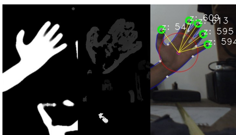
Figura 5. Proceso completo: HSV(izquierda), disparidad(centro) e imagen final(derecha)
