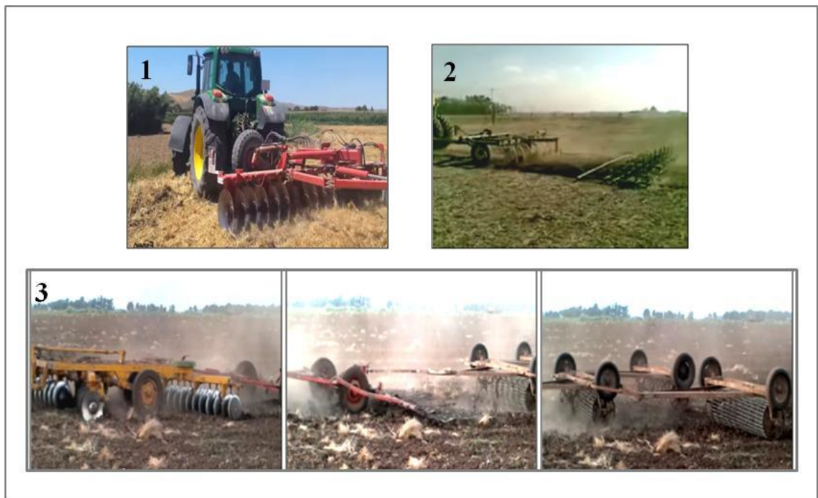
Figura II- 6: Secuencia de labranzas realizadas en el lote laboreado bajo labranza convencional (LC): Arado de Disco (1); luego Cincel con Rastra (2) y para cerrar Disco, Rastra de dientes y Rolo (3), de izquierda a derecha.
