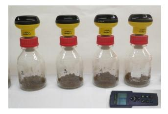
Figura 2.14. Sistema oxitop utilizado para medir la demanda bioquímica de oxígeno.
