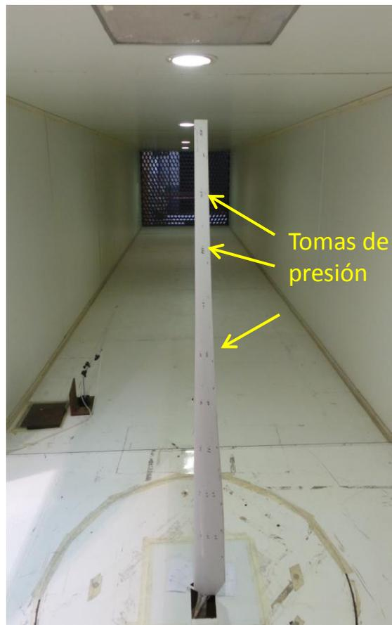
**Figura 2:** Pala en el túnel de viento.
