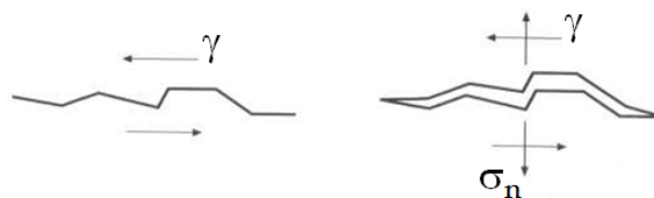
Figura 12 – Influencia de la tensión normal en la generación de daño por sollicitaciones de corte. (Ref.: [2])
