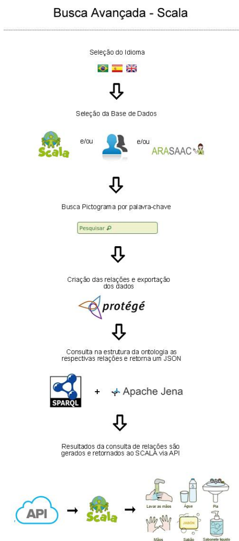
Fig. 8. Arquitetura do sistema de busca avançada
