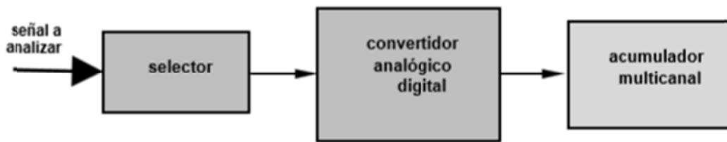
Figura 2.17 Diagrama de bloques de un analizador multicanal de altura de pulsos
