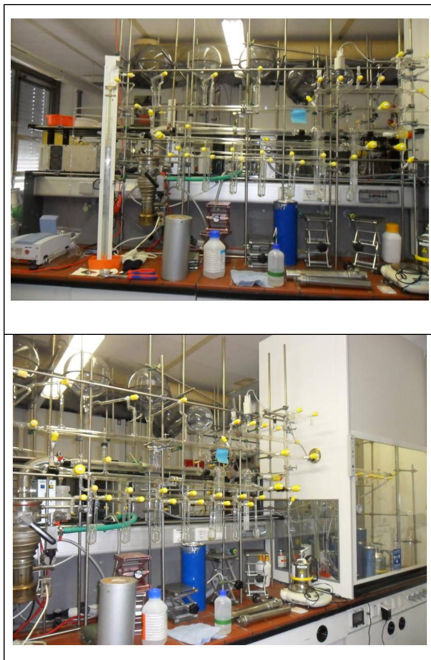
Figura 1. Línea de vacío instalada en el Laboratorio de Química Inorgánica a cargo del Prof. Dr. Mitzel en la Universidad de Bielefeld.
