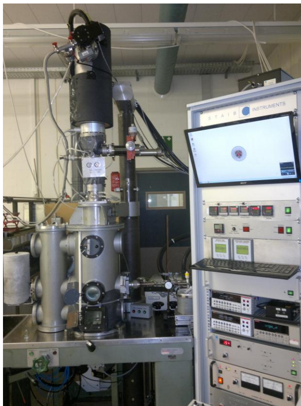
Figura 4. Sistema de medida de difracción de electrones en fase gaseosa.
