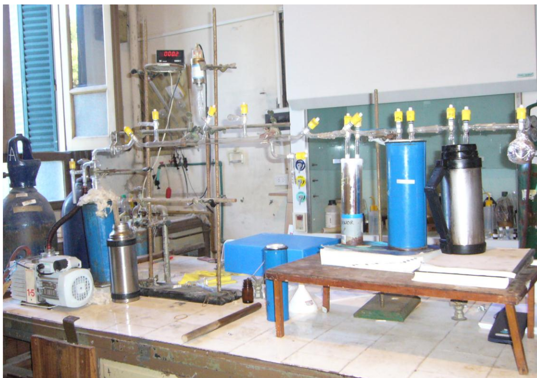
Figura 2. Línea de vacío instalada en el Laboratorio de Gases del CEQUINOR.
