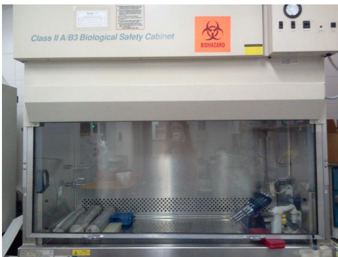
Foto 23: Cabina de Bioseguridad Biológica case II A/B3 es indicada para este nivel de bioseguridad.
