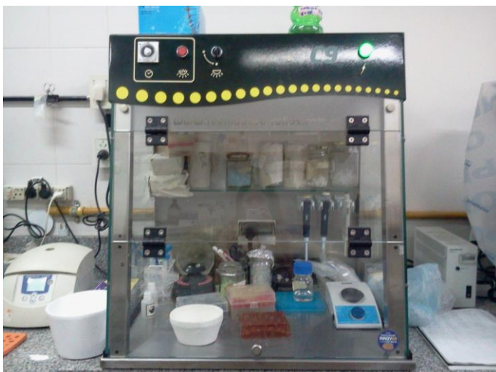
Foto 24: Cabina para preparación de productos. Es la correcta para disolver diferentes productos volátiles o no. Tiene luz interior y descontaminación por UV.
