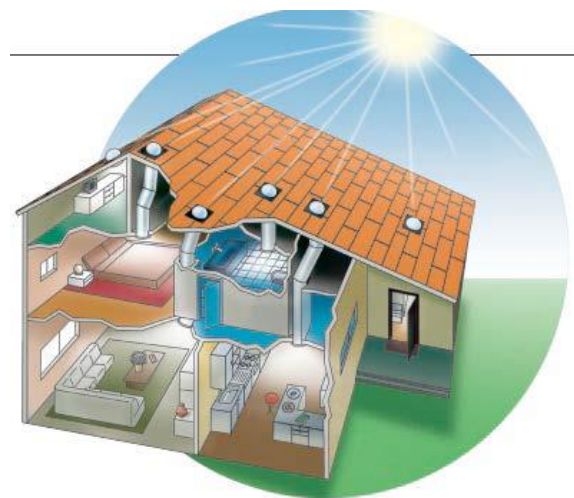
Figura 79: Ejemplo de ubicación de lumiductos
