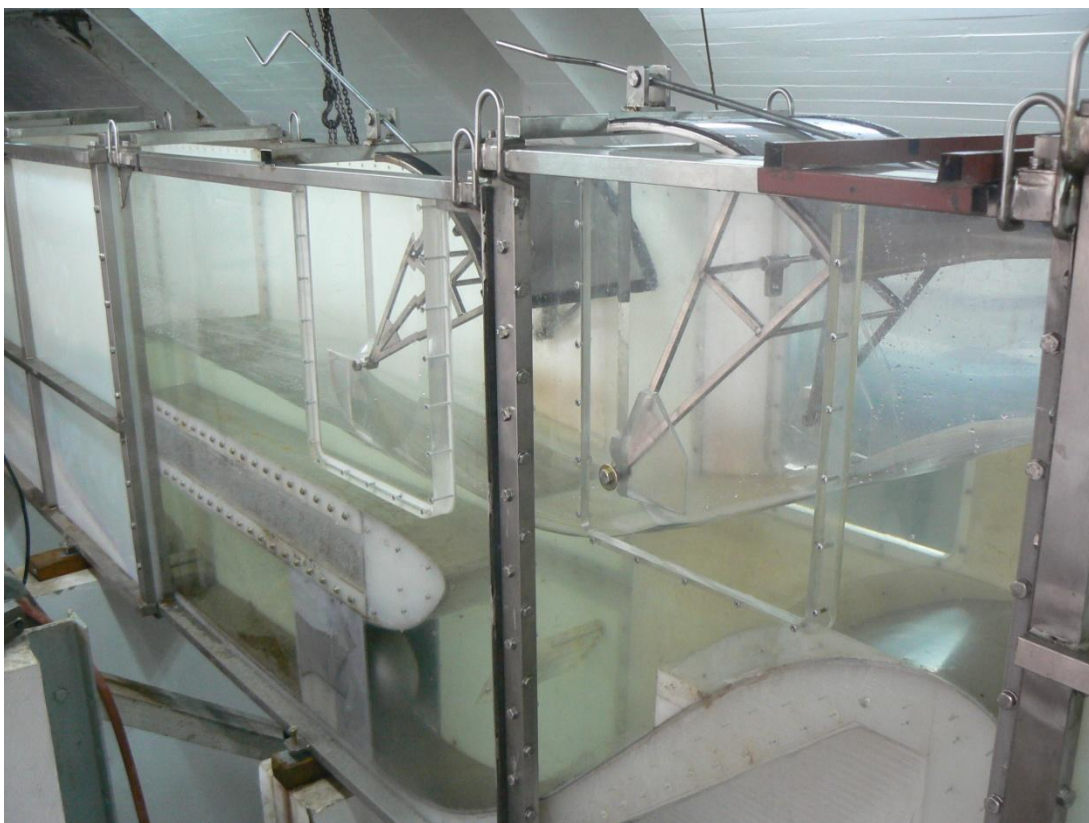
Figura 4.- Piezas fabricadas con control numérico. Funcionamiento en cota 80.00 msnm
