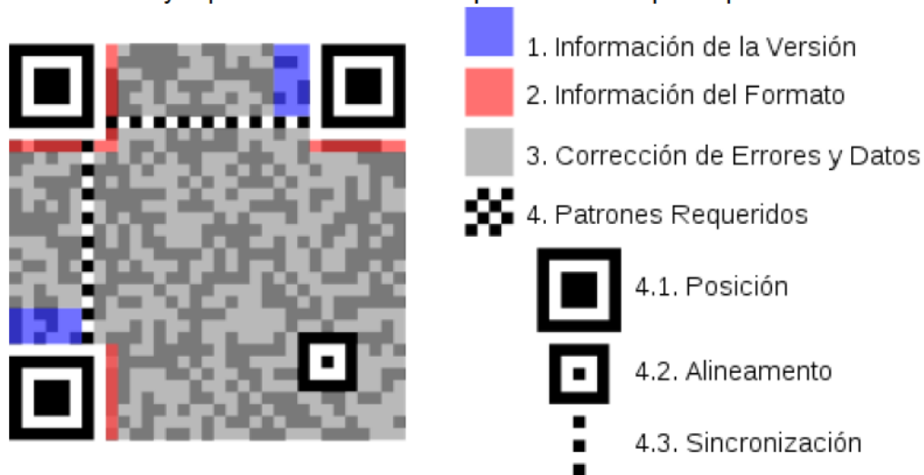
Figura 3.10: Estructura de un código QR
