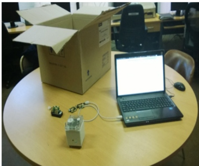
Figura 4 - Nodos sensores, nodo gateway, estación base y caja para pruebas
