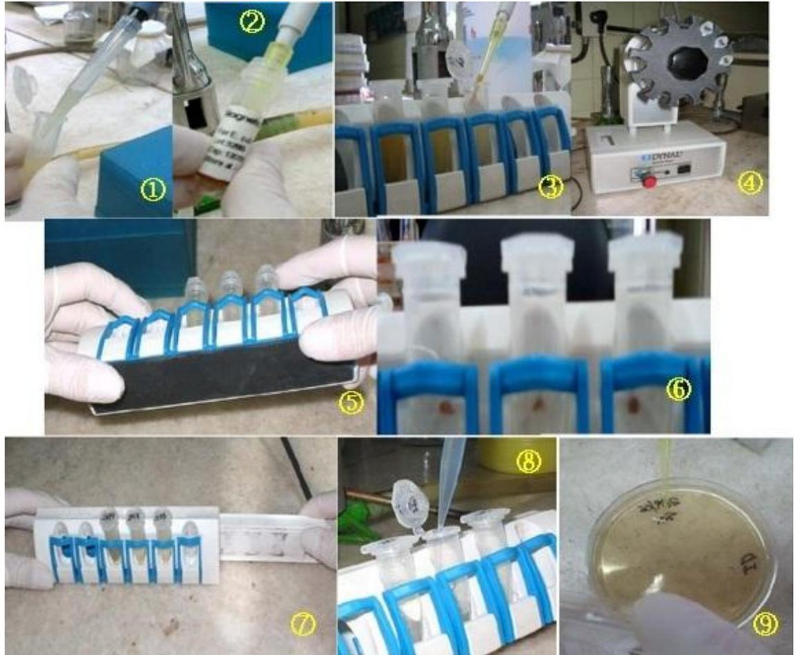
① Dispensación del enriquecido en un tubo eppendorf. ② y ③ Agregado de las perlas inmunomagnéticas ④ Incubación en un agitador rotatorio. ⑤ Colocación de los tubos en la gradilla imantada y agitación por inversión. ⑥ Formación del botón de perlas en la pared del tubo y eliminación del líquido. ⑦ Extracción del imán de la gradilla. ⑧ Agregado del buffer de lavado. ⑨ Siembra en las placas de las perlas resuspendidas.
