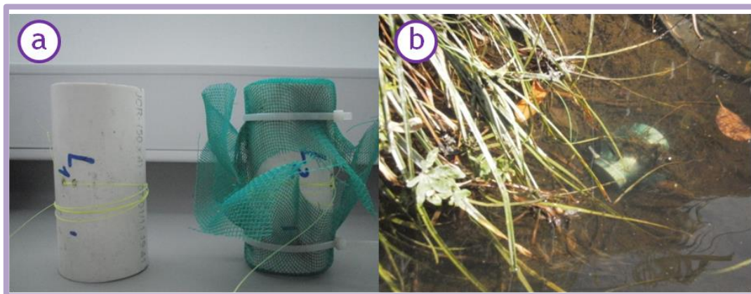
Fig. 5.7. a) Jaulas de PVC que se utilizaron en la experiencia; b) Jaula sujeta a la vegetación ripariana sumergida en el arroyo.
