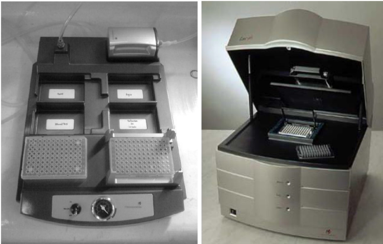
Figura 15- Equipo de purificación y separación de cadenas de los amplificadores de ADN (izquierda), y pirosecuenciador PSQ96MA (Derecha).
