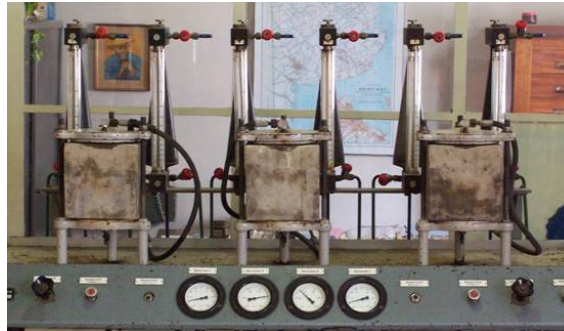
Figura 3.15. Equipo para evaluar la penetración de agua a presión.
