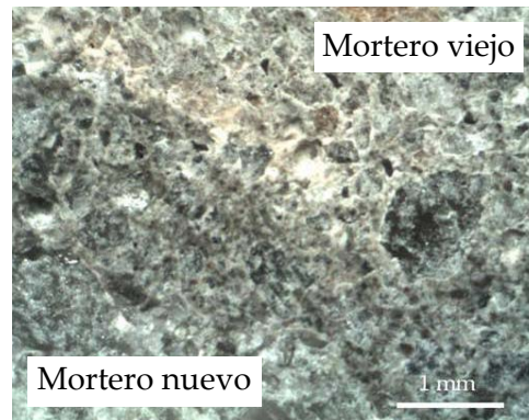
Figura 5.4. Interfaz mortero viejo-mortero nuevo.
