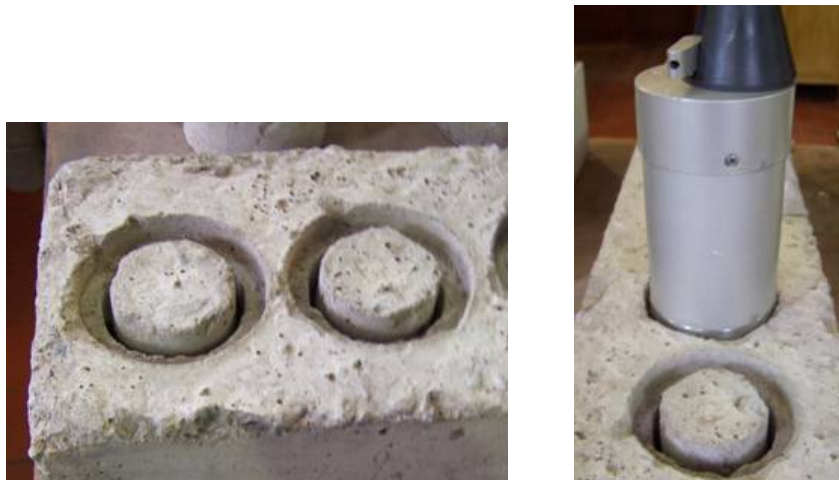
Figura 3.9. Testigo y base de apoyo de la celda de carga del ensayo Break-Off.
