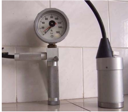
Figura 3.10. Celda de carga, válvula de presión y manómetro del equipo Break-Off.
