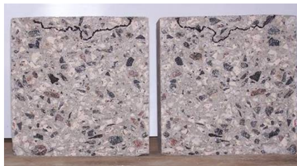
Figura 3.16. Perfil de penetración marcado sobre cada mitad de una probeta.
