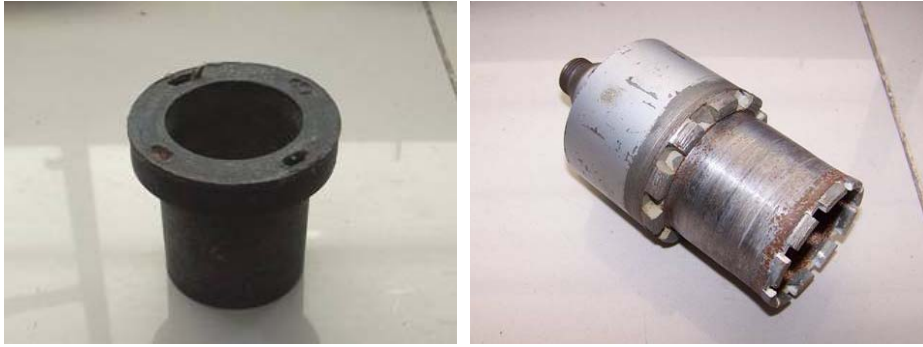
Figura 3.8. Molde plástico y broca diamantada para generar los testigos del ensayo Break-Off.
