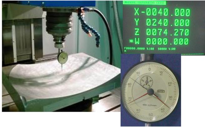
Figura 6.4 – Medidas de tolerancia de superficie
