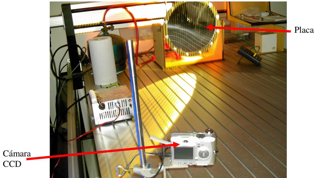
Figura 6.12 – Disposición experimental de medida de membrana con método ID.
