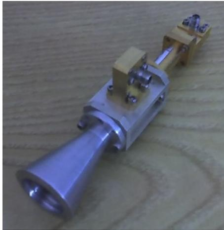
Figura 7.8 – Alimentador acoplado a OMT.
