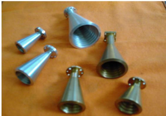
Figura 4.9 – Distintos modelos de Bocinas Cónica Corrugada.
