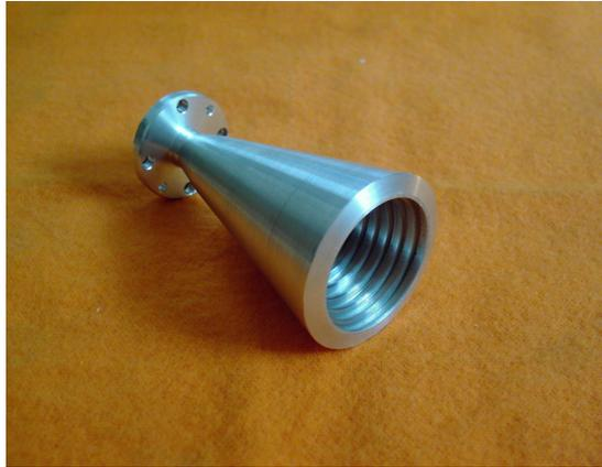
Figura 4.11 - Bocina cónica corrugada con frecuencia de funcionamiento central de 36,5 GHz.
