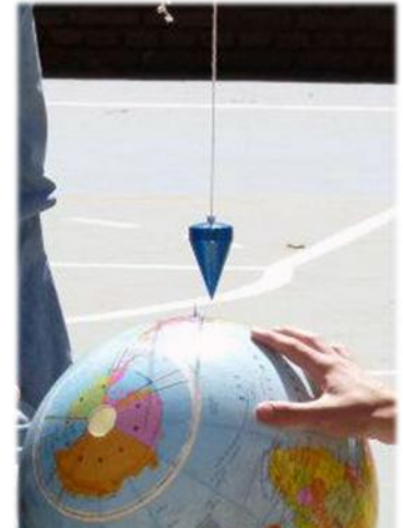
Fotografía 10. Con una plomada se puede poner en evidencia la vertical gravitatoria. Fotografía tomada por Patricia Knopoff en Villa Giardino (Córdoba) en septiembre de 2011.
