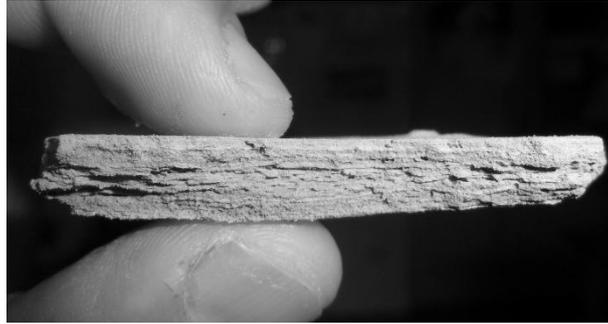
**Figura 1.5. Macrofotografía de agregados laminares formados sobre material parental expuesto a la acción climática, al cabo de 5 meses.**
