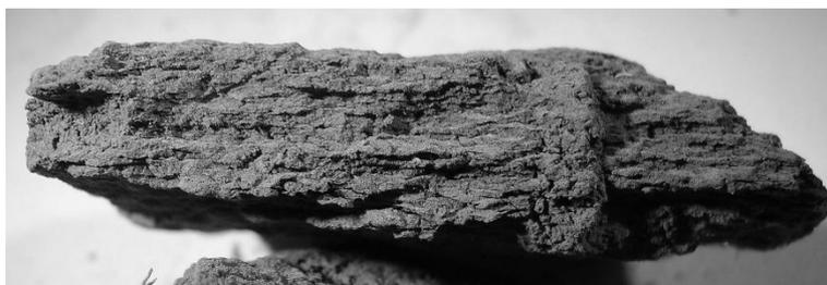
**Figura 1.4. Macrofotografía de agregados de suelos de la capa superficial (0-10 cm) de un suelo bajo siembra directa. La estructura laminar es evidente. Longitud del marco 70 mm x 24 mm (extraído de Soracco et al., 2010a).**
