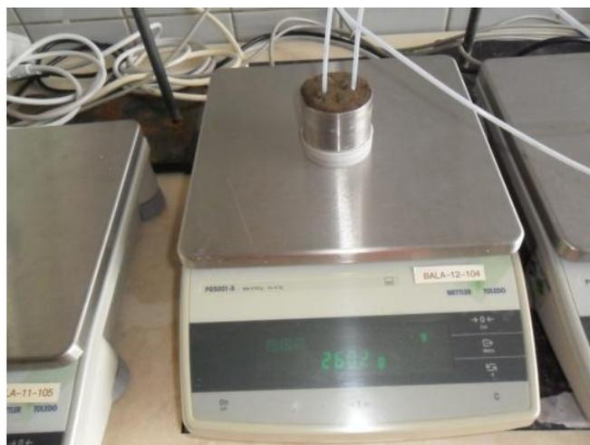
**Figura 4.2. Muestra preparada sobre balanza, y con dos minitensiómetros insertados a dos profundidades, para medición de conductividad hidráulica con el método Wind simplificado.**
