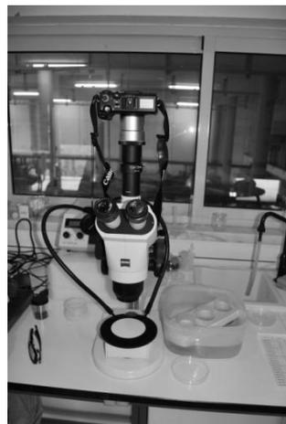
**Figura 11** - Lupa *stemi* usada para observar o estado dos ovos e larvas.
