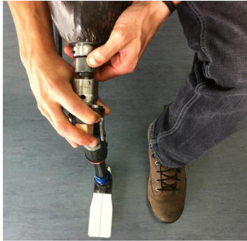
Figura 4-3: Teste da colocação e remoção do encaixe.
