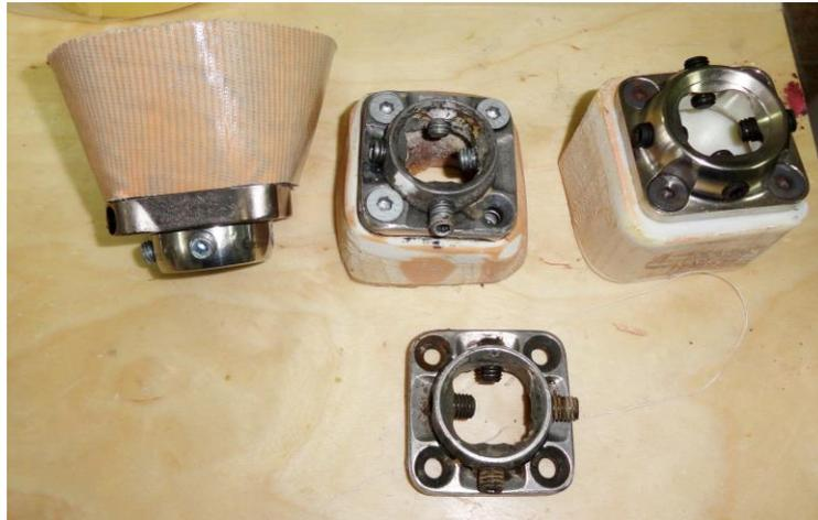
Figura 3-10: Procedimento de fixação de uma ligação ao encaixe.
