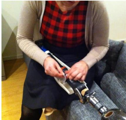
Figura 4-5: Teste da fixação do revestimento cosmético.
