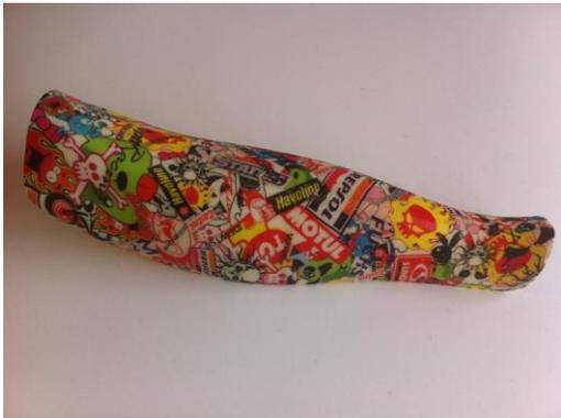
Figura 0-6: Resultado da impressão por transferência de água.
