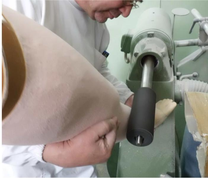
Figura 2-15: Conformação manual da espuma
