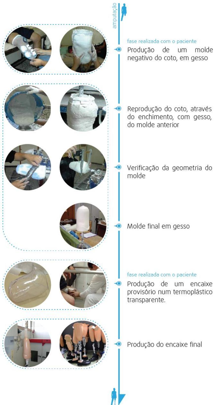
Figura 2-23: Desenvolvimento do encaixe protésico
