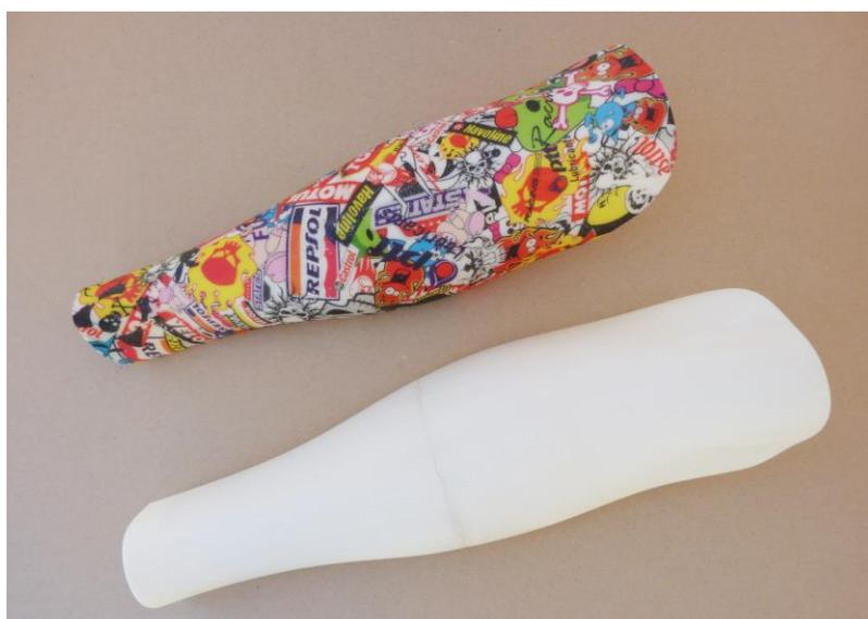
Figura 3-60: Aplicação do padrão, impressão por transferência da água
