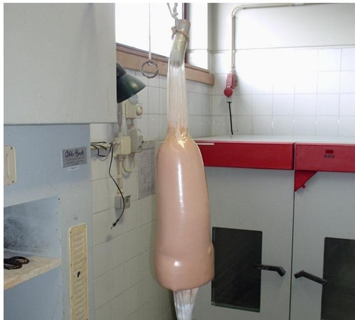
Figura 2-24: Processo de produção do encaixe em resina.
