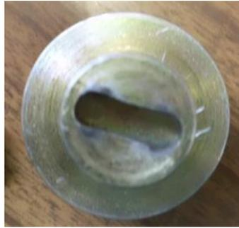
Figura 3-53: Deformações causadas pela má execução do ensaio de torção.
