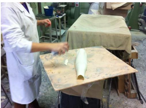
Figura 0-2: Aplicação do primário na superfície.
