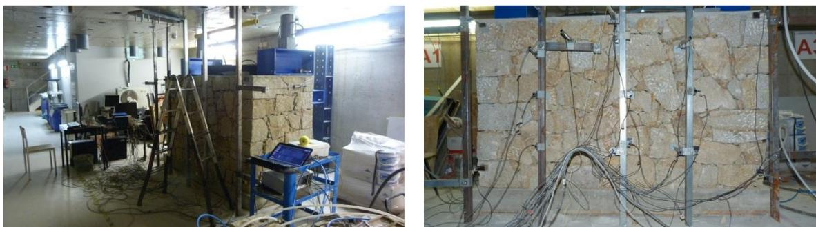
**Fig. 6 – Setup do ensaio e posicionamento dos LVDTs**
