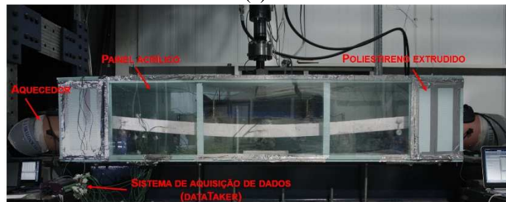
Figura 3. Configuração de ensaio: (a) Ensaio até à rotura; (b) vista geral da câmara.
