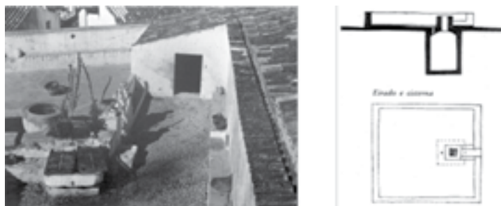
Figura 19 - Habitação com sistema de recolha de águas pluviais. Tunes, Silves [14]
