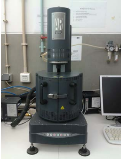
Figura 1: Reómetro AR-G2 utilizado no ensaio de reologia
