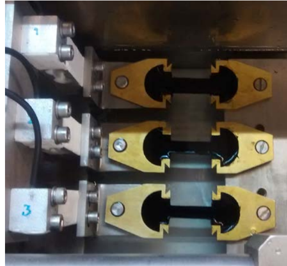
Figura 2: Amostras de betume a serem tracionadas no ductilómetro
