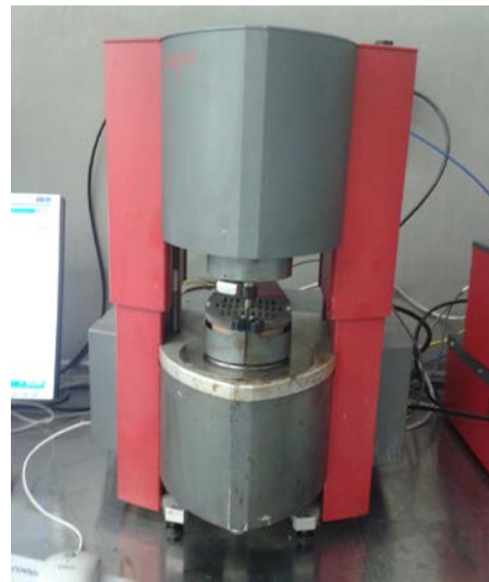
Figura 4: Reómetro de pratos paralelos utilizado no ensaio de fluência e relaxamento
