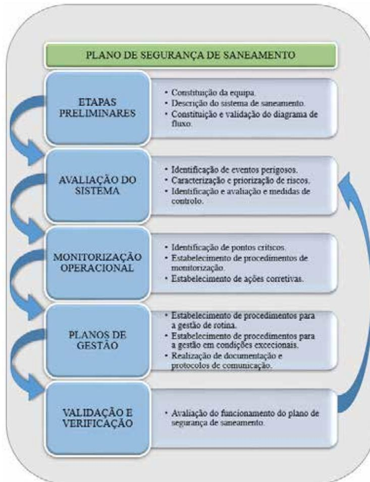
Figura 2. Estrutura de um PSS para a elaboração e implementação de um plano de segurança em sistemas de saneamento (adaptado de Vieira e Morais 2005)
