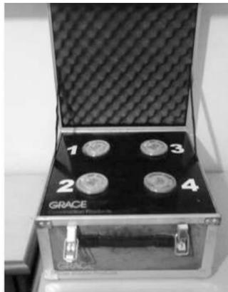
Figura 3.64: Calorímetro semi-adiabático AdiaCal (Fracalossi *et al.*, 2012).
