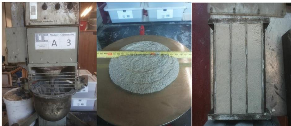
Figura 5: Preparação de uma mistura e dos respetivos provetes
