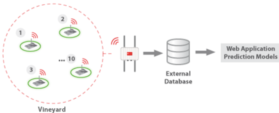
Figura 2.5: Esquema de la arquitectura utilizada por el sistema SIEGA para viñedos.
