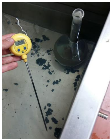
Figura 39. Baño maría de muestra a 25°C.
