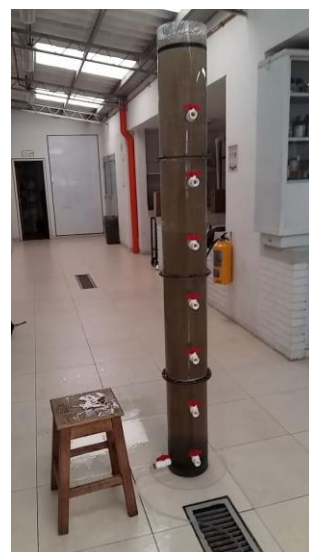
Figura 48. Columna de sedimentación 5 min. De ensayo
