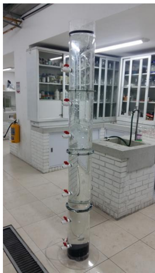
Figura 47. Columna de sedimentación sin muestra
