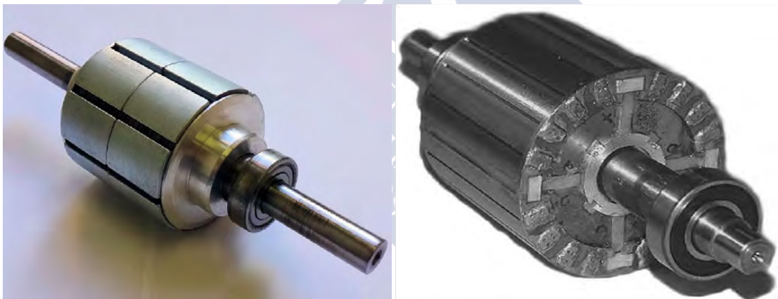
Figura E.6. (a) Rotor de una SPMSM [Wu 2015], (b) rotor de una IPMSM [Rahman 2013].
