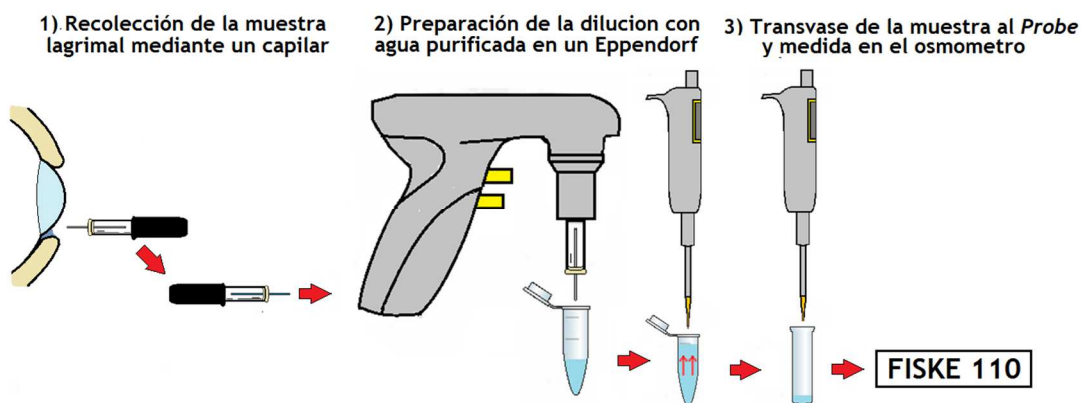
Figura 3.19. Proceso de recolección, dilución y medida de la lágrima con el osmómetro Fiske 110
