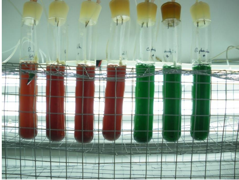
Figura 5 - Sistema de cultivo de microalgas ( Rhodomonas lens y Chroomonas placoidea ) en fotobiorreactores de 80 mL.
